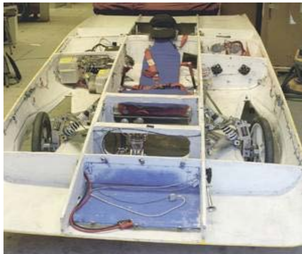
Figure 3.1.5---Monocoque Body (Kruschandi, 2005)
